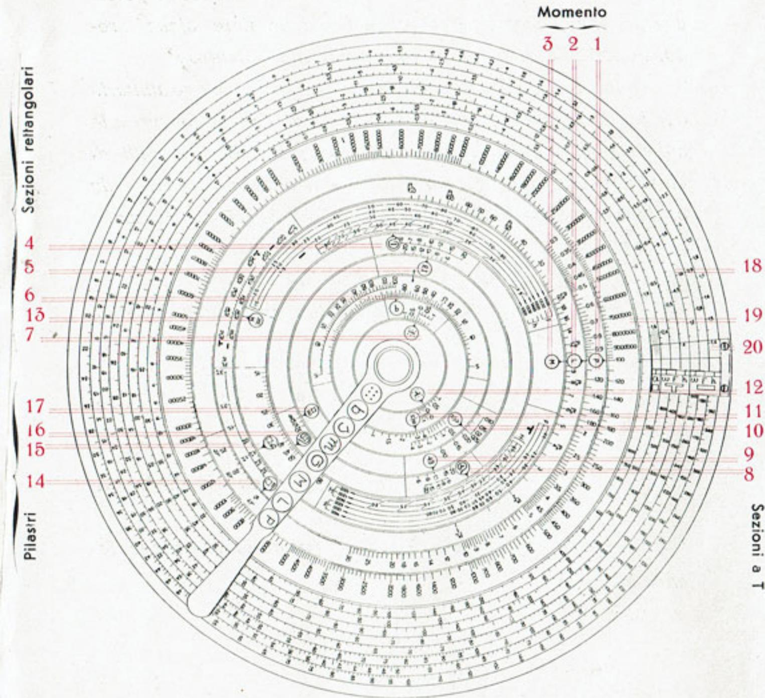
modo la formula del ferro  $f = \beta \sqrt{M \cdot b}$ ; per il calcolo della sezione staffe si portano gli stessi indici come per il calcolo del ferro escluso l'indice ( $\delta$ ) dei Momenti; in suo luogo si prenderà l'indice ( $1\delta$ ) per il calcolo delle staffe risolvendo in tal
